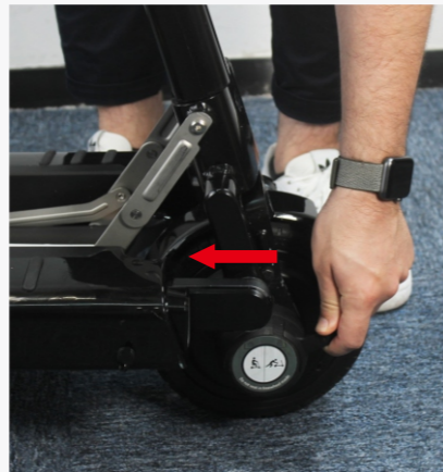
Fig. 21 : Désactiver le mode roue libre
