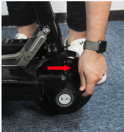
Fig. 20 : Activer le mode roue libre
